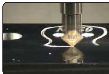
● Centrado, Ranurado, Grabado en centros de mecanizado.
