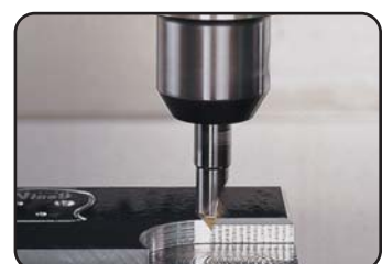
● Achaflanar contorneado en centro de mecanizado.
