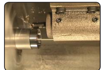
● Torneado, Avellanado, Refrentado en centro de torneado CNC.
