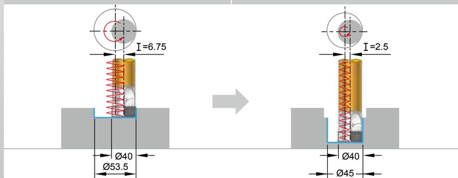
► **Un seul et même “NC Helix Drill” peut réaliser des perçages de différents diamètres et profondeurs ! >>**
